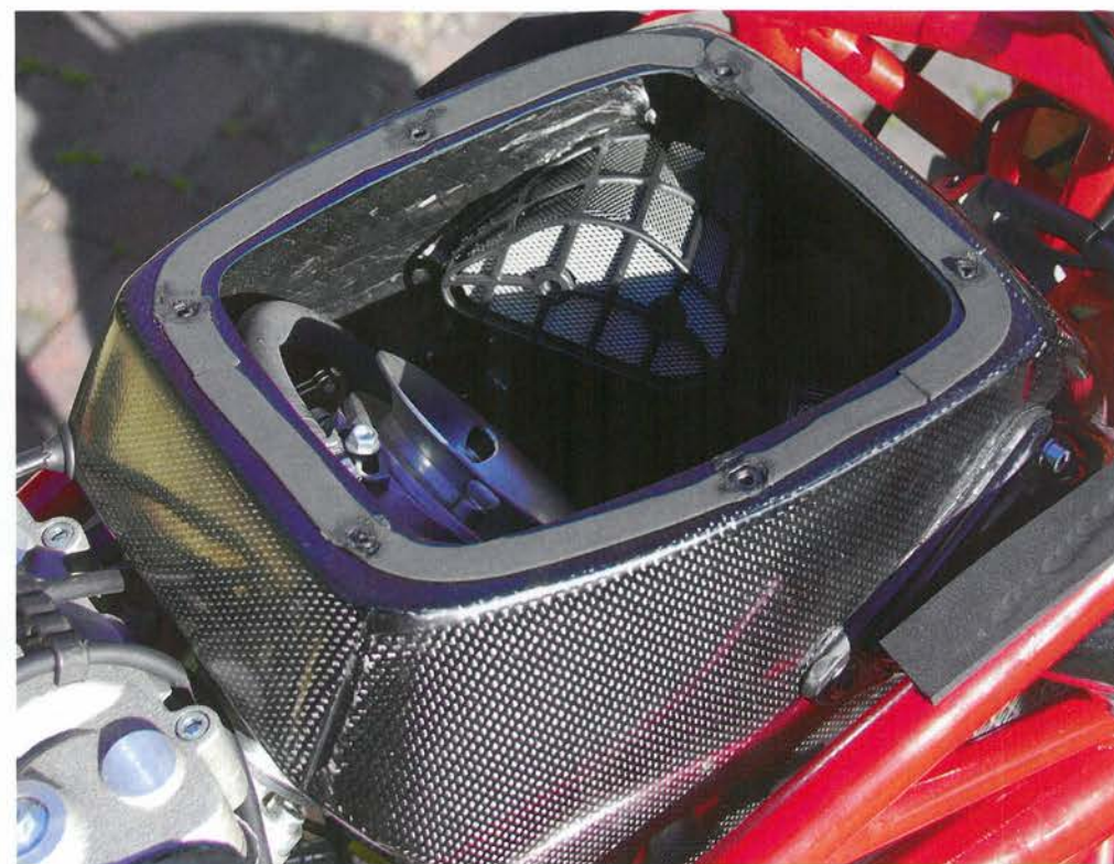
Un particolare dell'airbox in fibra di carbonio, anch'esso realizzato su misura per la GPM. Al suo interno ci sono i due corpi farfallati da 60 mm di diametro dedicati all'impianto di alimentazione.
